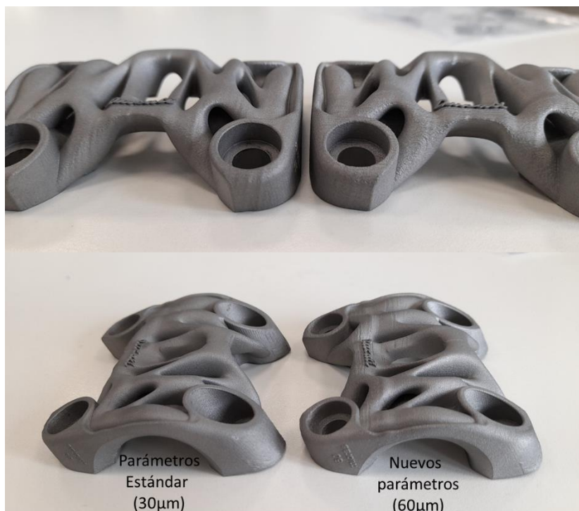
Ilustración 50. Potencia fabricada con parámetros estándar (30 µm ) y nuevos parámetros (60 µm)
