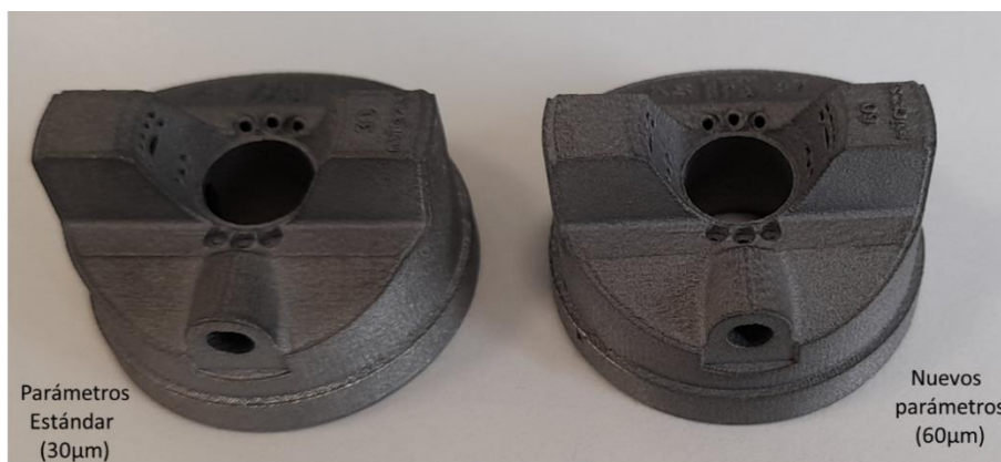
Ilustración 47. Boquilla fabricada con parámetros estándar (30 μm) y nuevos parámetros (60 μm)
