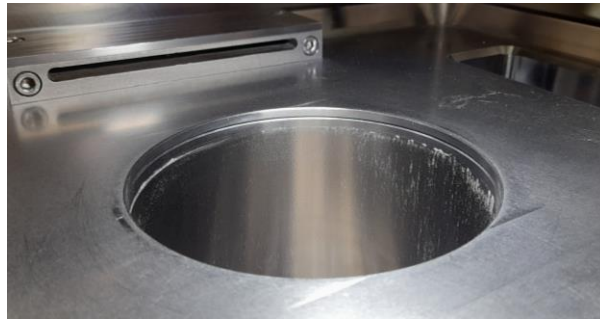
Ilustración 7. Detalle del polvo que queda en la camisa del cilindro
