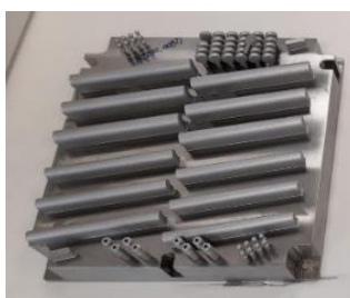
Ilustración 10. Muestra de una de las fabricaciones de la máquina PG250 para la caracterización del material con parámetros estándar
