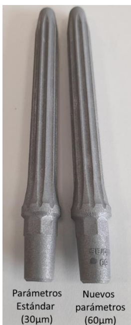
Ilustración 49. Vástago fabricado con parámetros estándar (30 µm) y nuevos parámetros (60 µm)
