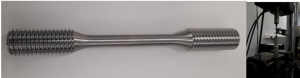
Ilustración 25. Mecanizado de probetas para el ensayo de tracción y ensayo de tracción
